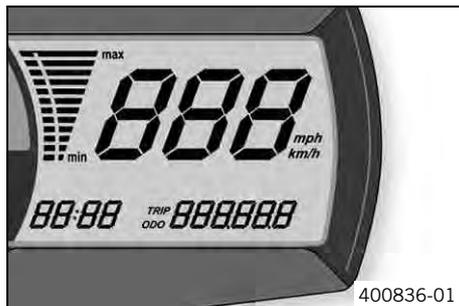
Quando si attiva l'accensione, ai fini del test funzionale si illuminano per un secondo tutti i segmenti del display.
