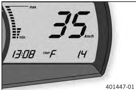
Quando il livello del carburante ha raggiunto la riserva, la visualizzazione passa automaticamente a **TRIP F** e inizia a contare da **0.0** indipendentemente dalla modalità di visualizzazione attivata in precedenza.
