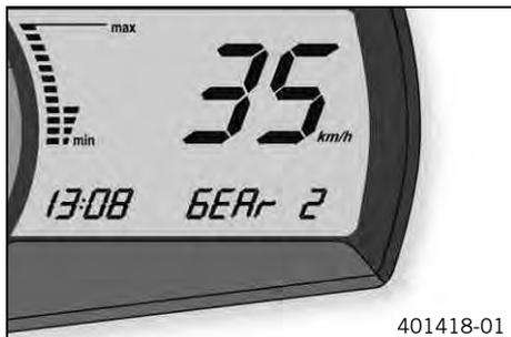
In modalità di visualizzazione **GEAR** viene indicata la marcia inserita nella trasmissione.
